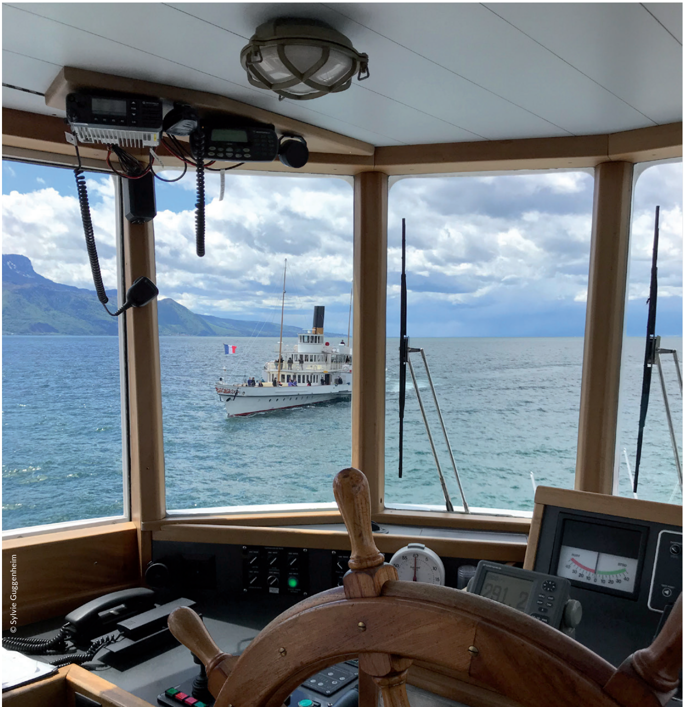
Dans la timonerie de La Suisse: le gouvernail en bois n'est utilisé qu'en cas de problème avec le système de pilotage électrique.
