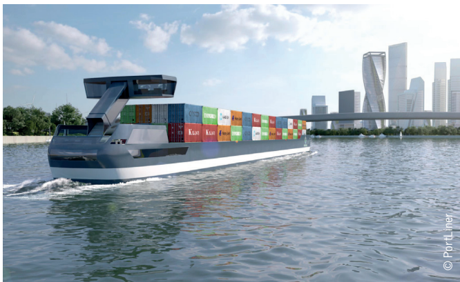
Cargo. Avec des ponts atteignant 5,6 mètres, seulement deux hauteurs de conteneurs peuvent être chargées sur le cargo électrique.
